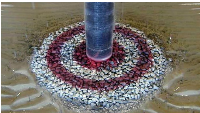
Ejemplo de laboratorio de la socavación alrededor de un pilar, provocada por oleaje y corrientes. © DHI
