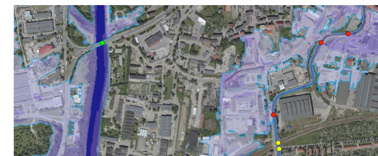
Fragment mapy prezentującej strefę zalewową z dodatkową informacją o przejezdności mostu (zielony punkt), piętrzeniu wody na konstrukcji mostu (żółty punkt) i przelewaniu wody przez most (czerwony punkt). http://elblag.eu
