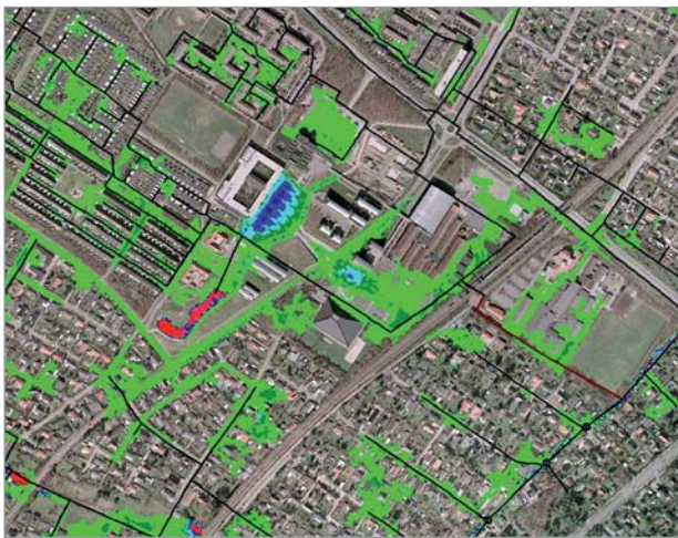
Abb. 1: Beispiel der Analyse eines Extremereignisses mit der Kopplung zwischen Kanalnetz und 2D-Oberflächenmodell
