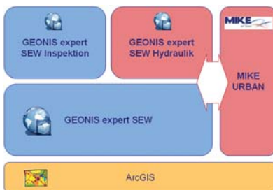
Abb. 1: Schematische Übersicht der Integration von GEONIS Expert SEW und MIKE URBAN auf Basis von ESRI ArcGIS
