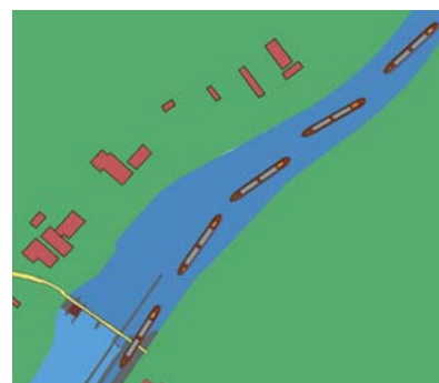
Abb. 2 a) und b): Bereich „Filter“ und Ergebnisdarstellung in der Karte unter Verwendung eines Zeitintervallfilters – Position des Binnenschiffs im 120 Sekunden-Intervall
