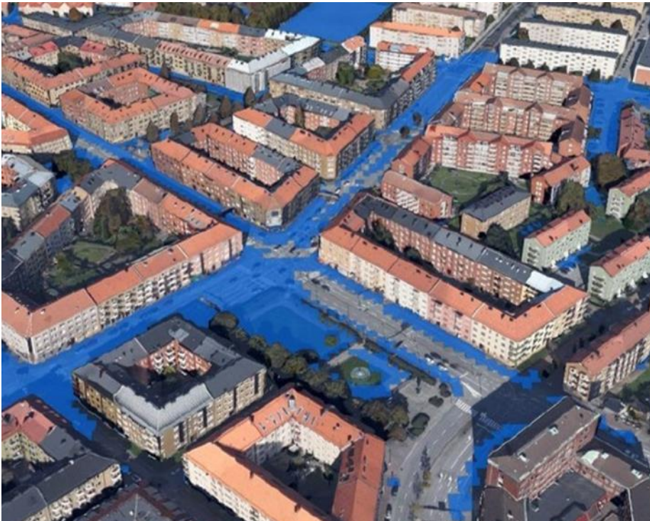
Ansicht mit berechneten, maximalen Wassertiefen
