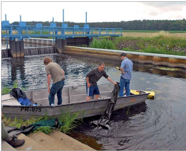
Abb. 2: Vorbereitung zur Fließgeschwindigkeitsmessung mit dem QLiner. (Foto: Saskia Petersen, HU-Berlin, 6.7.2012)
