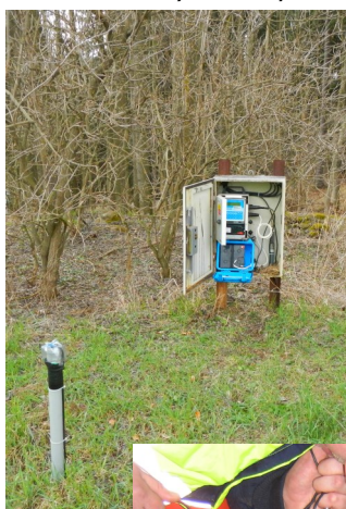
Měření hladiny mělké podzemní vody a porovnání se simulací modelem MIKE SHE
