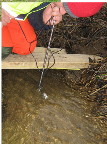
Hydrometrování vrtulí OTT a porovnání zjištěného průtoku se záznamem
