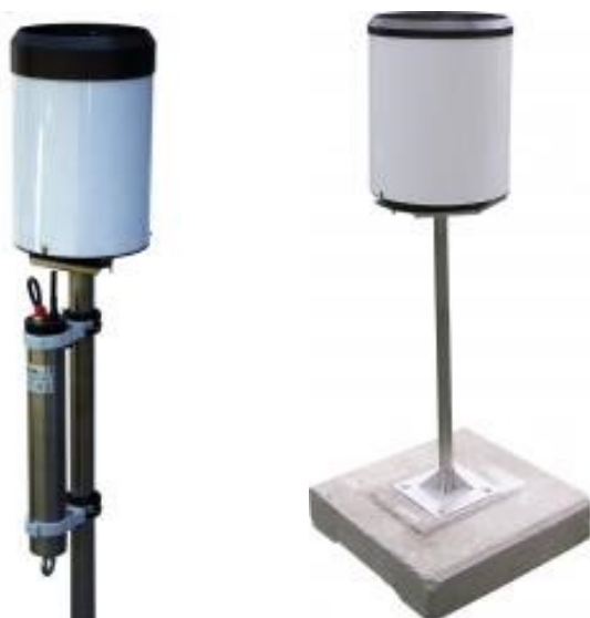
Srážkoměry SR02 (vlevo) a SR03 (vpravo) © DHI / Foto: www.fiedler.company
